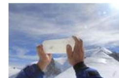
© CNRS Photothèque : Bruno Jourdain Opérations de forage au col du Dôme, à 4250 m, dans le massif du Mont-Blanc, dans les Alpes. Carotte retirée à 120 m de profondeur : la présence d'un fragment de roche indique que le socle rocheux est atteint.
